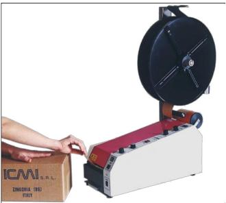
Le umettatrici EL-5 sono in grado di distribuire strisce di carta gommata umidificata e quindi pronta per sigillare le scatole in cartone. Si possono programmare 2 lunghezze di nastro che possono essere erogate a tempo ed in successione. Possibilità di riscaldare l'acqua per una perfetta attivazione della colla. Possono essere usati rotoli con gommatura interna od esterna. Massima silenziosità in stand-by: il motore viene attivato solo dopo aver premuto il tasto di avvio al programma.
